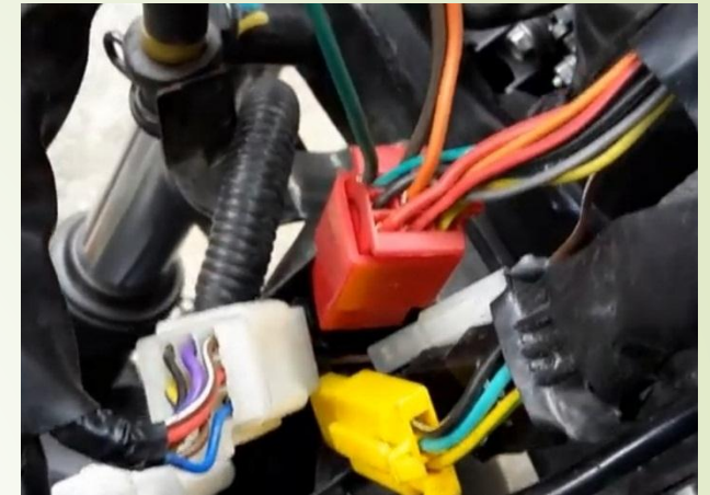
Conectores dentro del carenado. Extremo que llega desde el mando.
